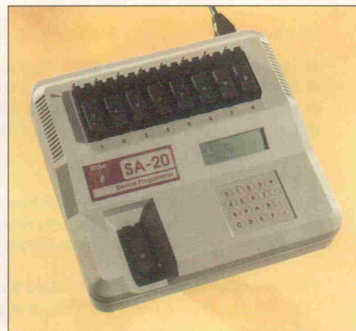
Bild 9 und 10. Zwei Vertreter der 'Ganged'-Klasse von digelec und Wilke. Sie können jeweils 8 EPROMs gleichzeitig brennen. Wilkes SA-20 hat noch eine zusätzliche Fassung für das Master-EPROM.
